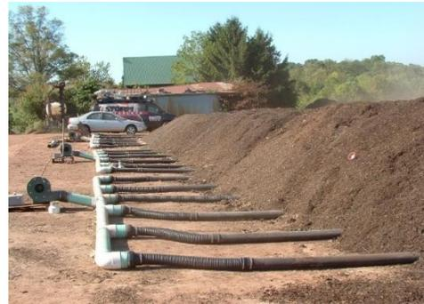
Figure 6: Système en andains statiques aérés
