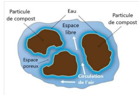
Figure 23: Circulation de l'air dans le compost
