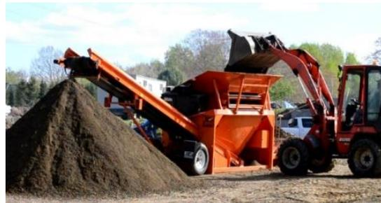
Figure 14: Tamis mécanique
