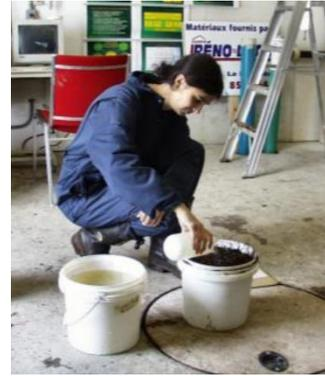
Figure 26: Test de porosité
