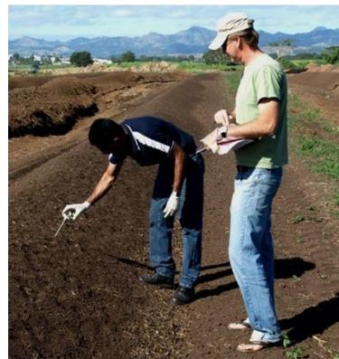
Figure 19: Prise de température
