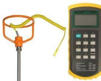
Figure 21: Thermomètre digital avec sonde
