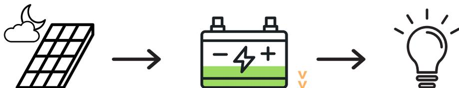
**Si les batteries sont vides et s'il n'y a pas de rayons de soleil à capter avec les panneaux**, il est possible d'utiliser la génératrice à essence pour les recharger. Cette recharge dure généralement entre 1 et 2 heures. Il faut ensuite fermer la génératrice et laisser les batteries alimenter à nouveau le système.
